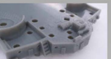
▲艦橋基部の壁面は、造形を表現するためスライド金型を起用。
