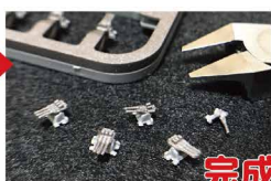
接着位置合わせ済みの部品に流し込み接着剤を流す。
